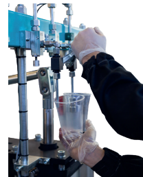
Manual Mixing Ratio Control Unit Auslitervorrichtung zur manuellen Mischungsverhältniskontrolle
